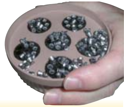
5. Ladehilfe absetzen, Trommeln entnehmen und ebenbündig eindrücken
